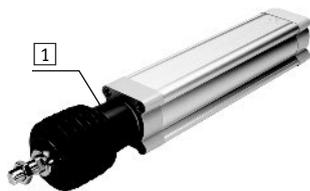
Защитный гофр является полностью герметичным. Для предотвращения попадания пыли и химически агрессивных сред в защитный гофр соединение его внутренней полости с атмосферой должно осуществляться через специальное (вентиляционное) отверстие [1].
